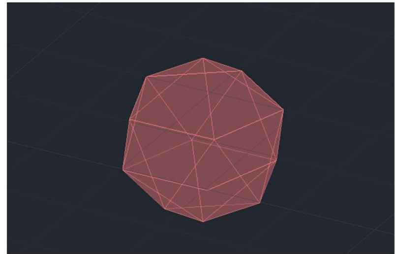
Cópia da parte superior e rotação para a parte de baixo para ter o sólido completo
