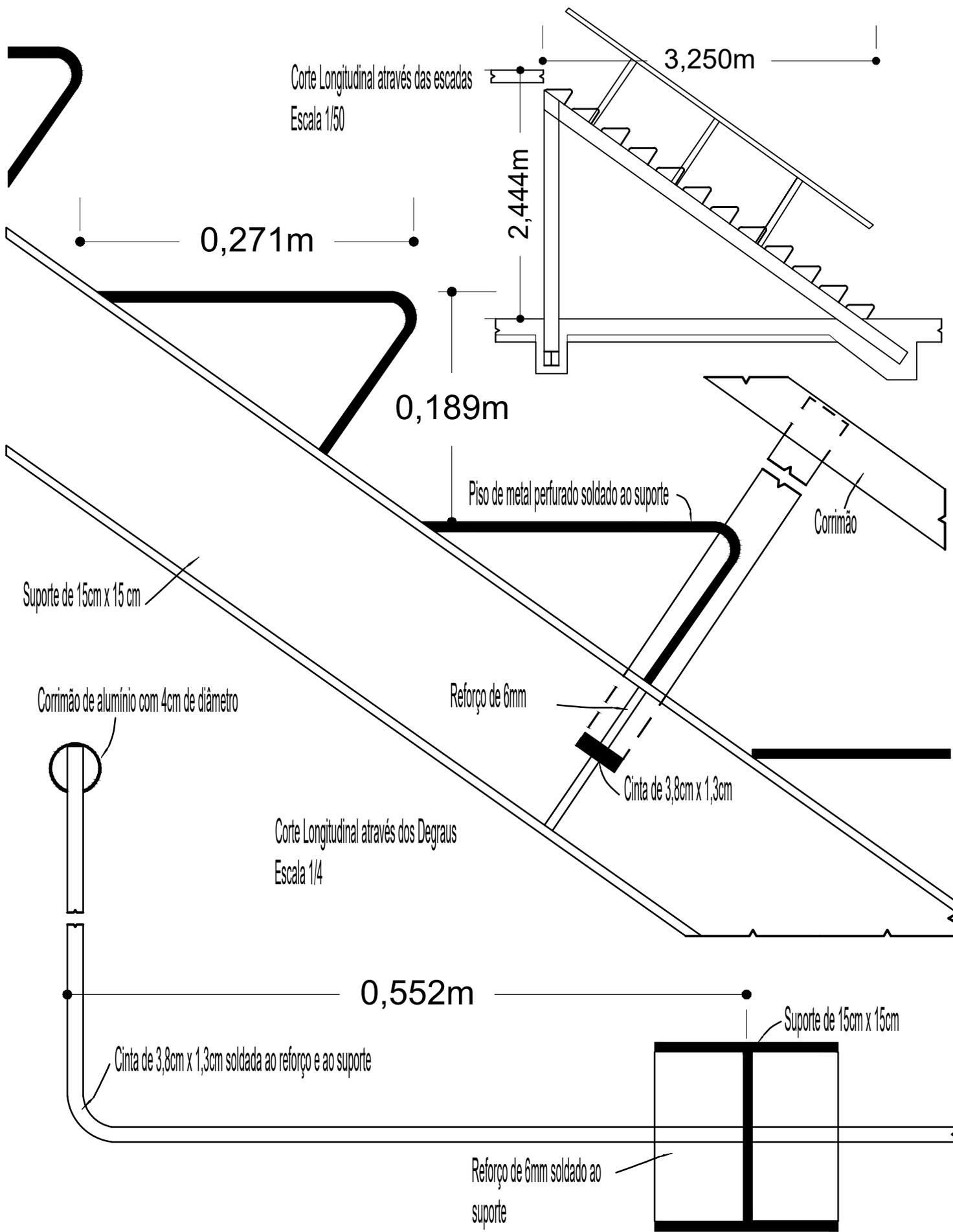
Corte Transversal através do corrimão mostrando a junção com o suporte
