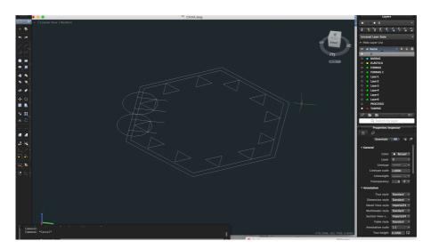
\_ fez-se extrude do pentágono anteriormente desenhado com uma altura de 1,5 cm \_ duplicou-se a planificação das paredes para se poderem usar para criar os buracos para que as paredes encaixassem do hexágono e para contruir as paredes;
