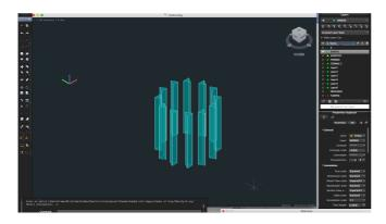
\_ na face superior foram desenhadas as figuras para serem cortadas usando os cmds polygon e circle – circulo, triangulo, quadrado e pentágono. Fez extrude e posteriormente um subtract das figuras no hexágono para que ficassem buracos para que as figuras conseguissem ser inseridas.
