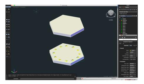
\_ fez-se extrude dos triângulos para desenhar as paredes. As paredes ficaram com 16cm – 15cm visíveis e 1cm encaixado nos hexágonos (0.5 em cada lado). Fez-se fillet edge a todas as arestas das paredes.
