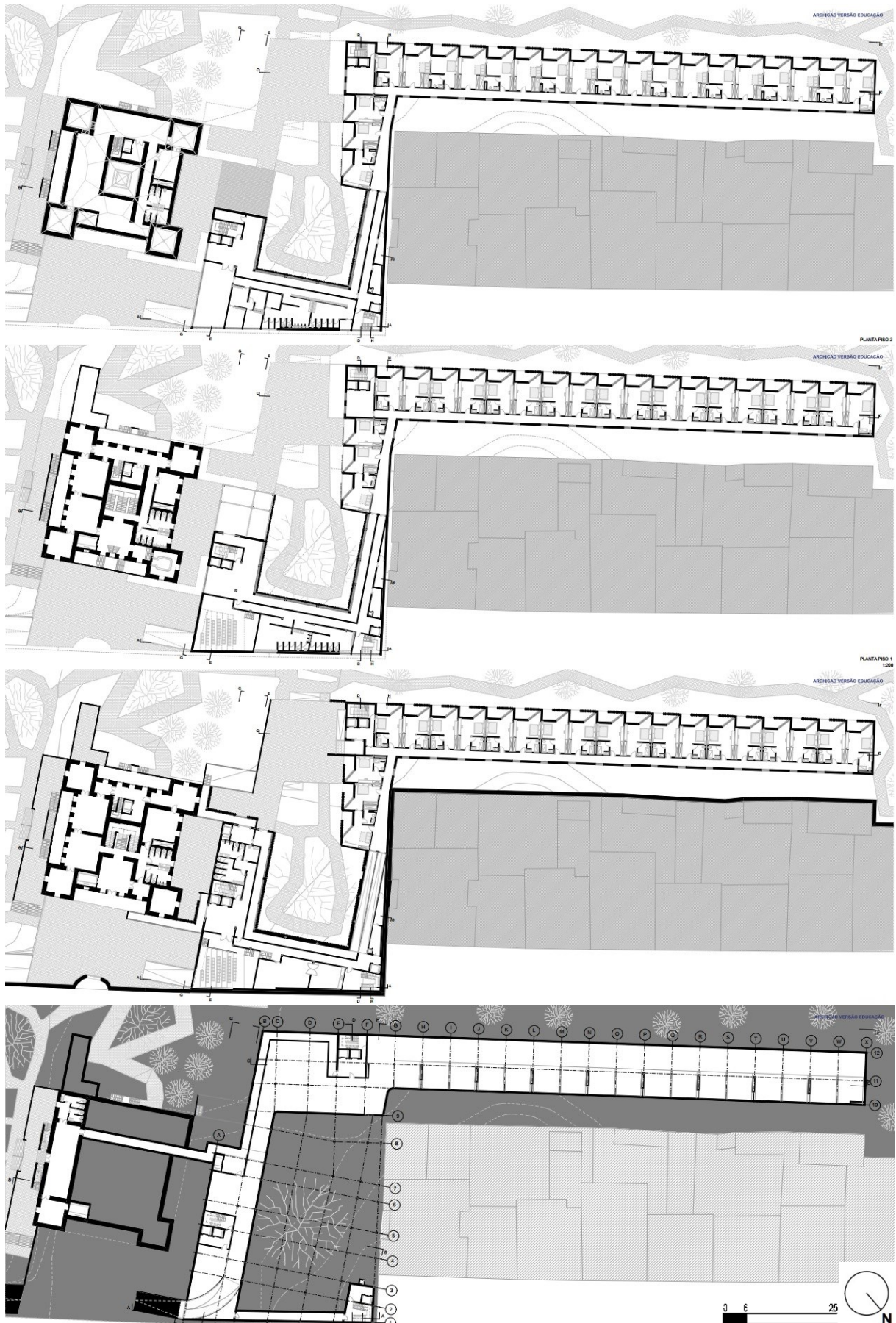
Anexo 80 – Plantas da proposta para o edifício novo, pisos 2, 1, térreo e estacionamento, respetivamente, autoria própria, 2019
